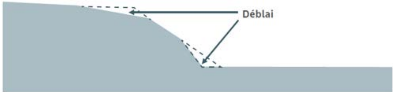
Figure 39 – Exemple de déblai
