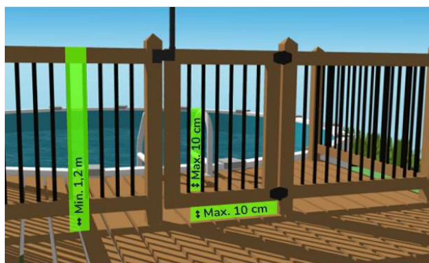
Figure 3 - Dimensions exigées pour une enceinte
